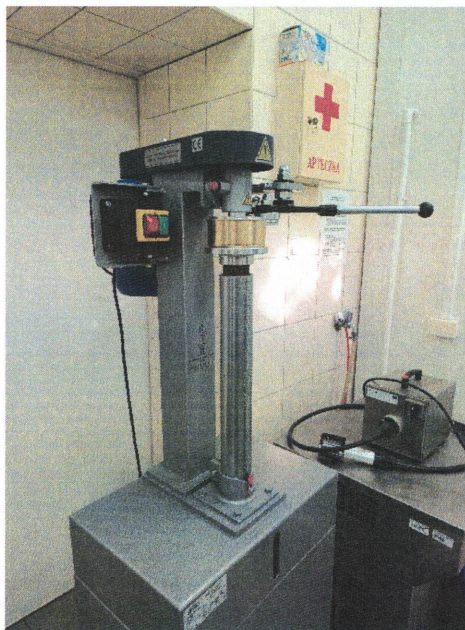
Fot. 15. Półautomatyczna zamykarka do puszek (fotografia własna).
