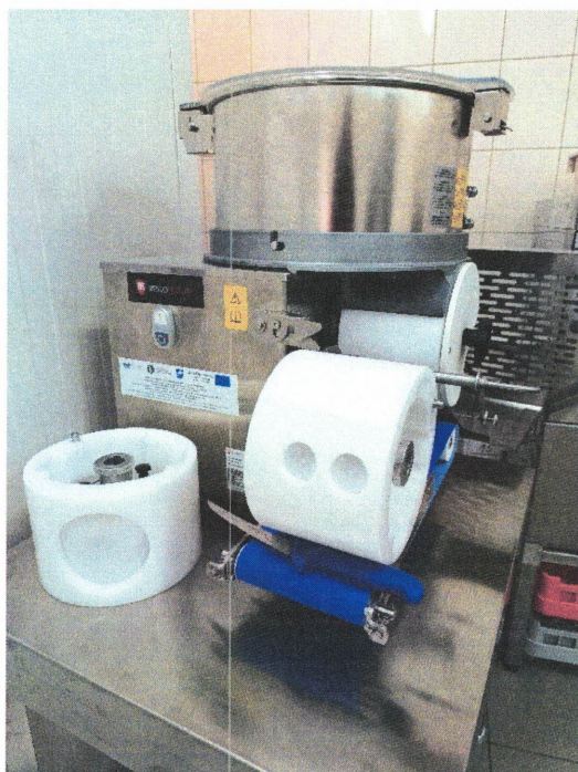
Fot. 19. Wymienne głowice do formierki i uformowane bolsy (fotografia własna).
